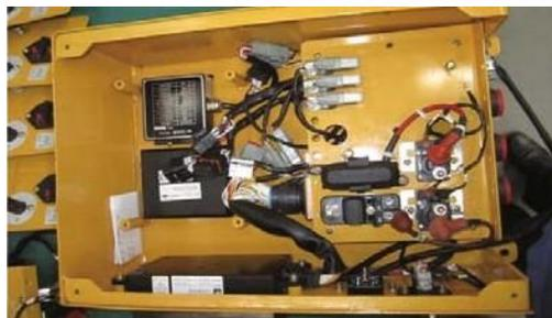
L'écran LCD 16 touches et de couleur, le contrôleur MC et l'entraînement à réluctance variable composent le système de contrôle de puissance.
